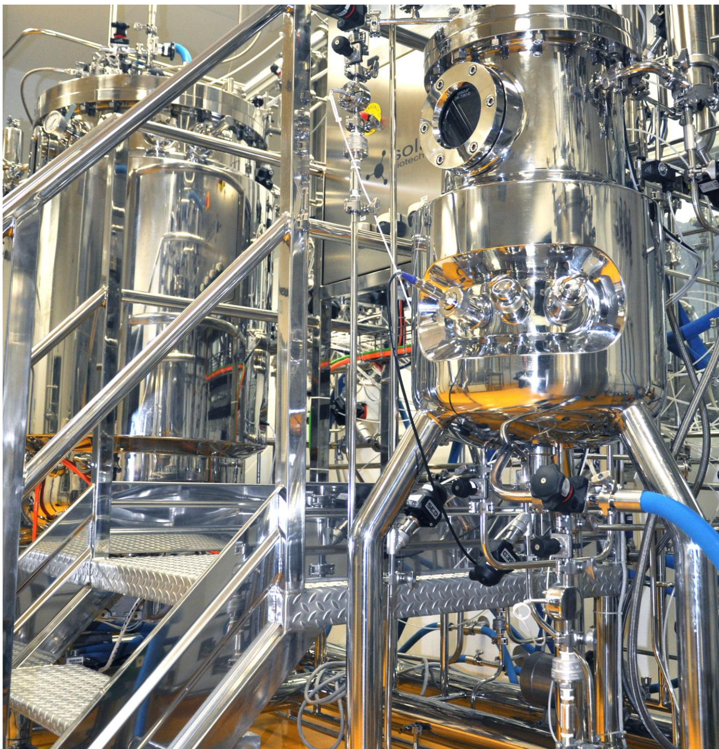
Bioreactorul SOLARIS SBI400 asigură un proces eficace de cultivare a antigenilor virali. Bioreactorul are un volum de lucru de 300 de litri și produce maximum 600 de litri de antigen care conține 40-80 de unități internaționale pe mililitru (IU/ml) de glicoproteină (după inactivare) pe lună.
